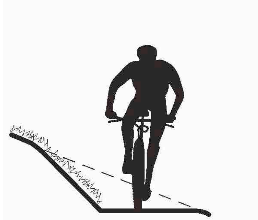
Figure 6.3- Edge battering (Image courtesy IMBA)
